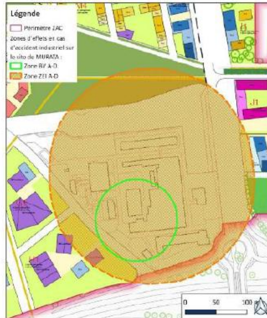
Figure 246 : Superposition du projet d'aménagement stade création de ZAC aux zones d'effets en cas d'accident industriel sur le site MURATA
